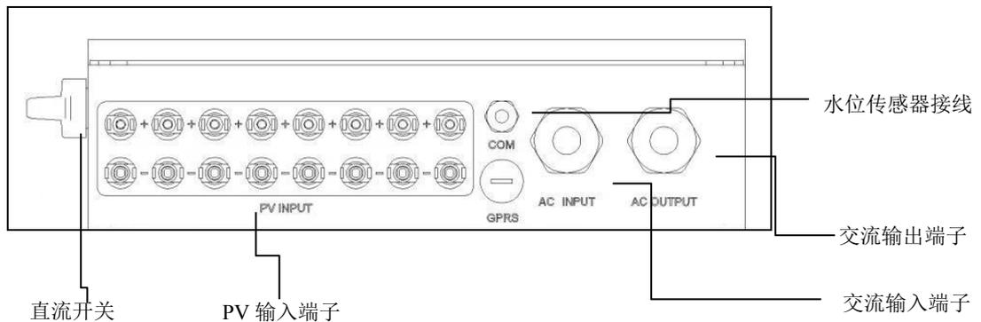
图 2-9 LS-PI- 13K to30K 接线端子示意图
