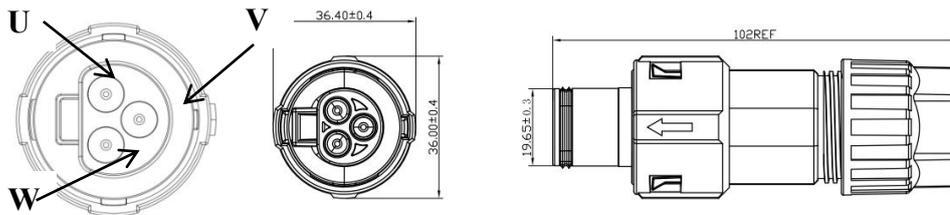
图 2-16 端子内部接线示意图
