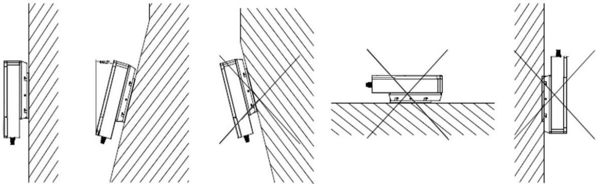
图 2-8 正确放置逆变器示意图
