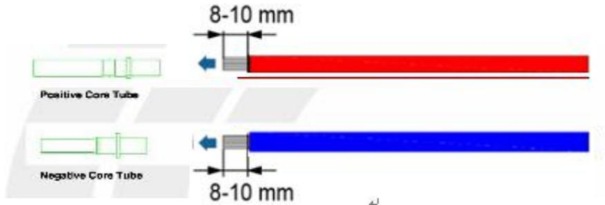
图 2-5-1 直流输入线连接示意图
