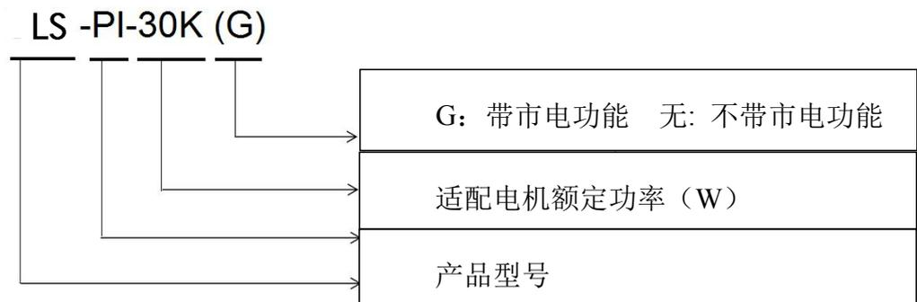
图 1-5 产品铭牌及型号说明 (Example :30KW)
