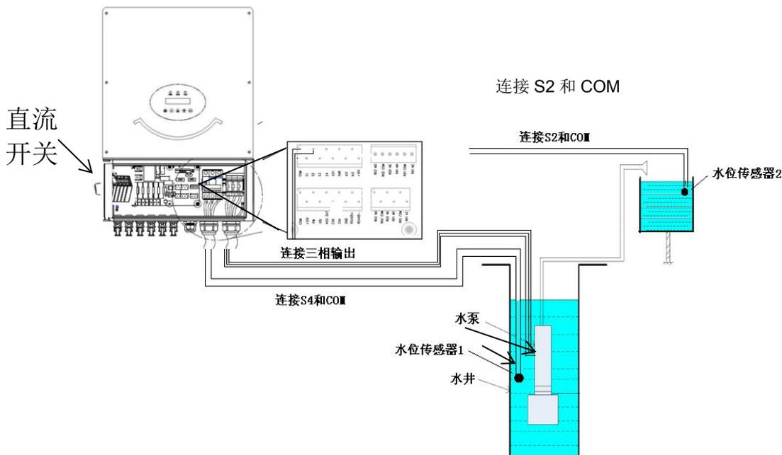
图 2-5-4 水位探测器接线图
