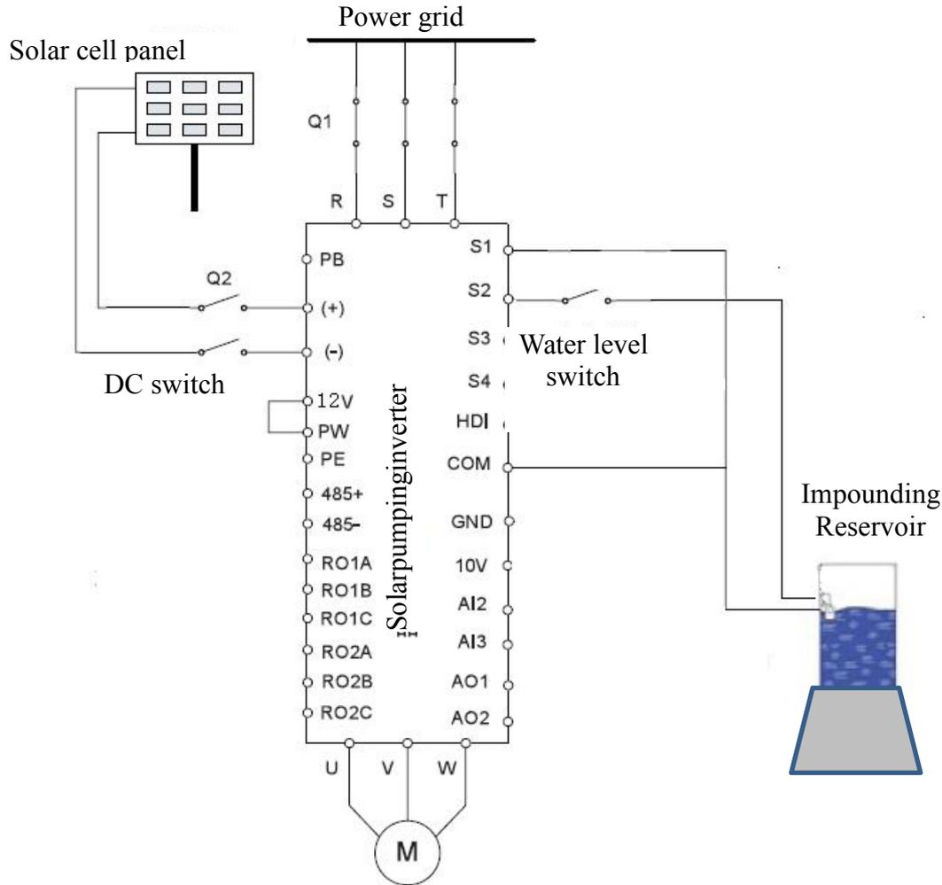
2、先将 Q2 开关断开，再将 Q1 开关闭合即可。
