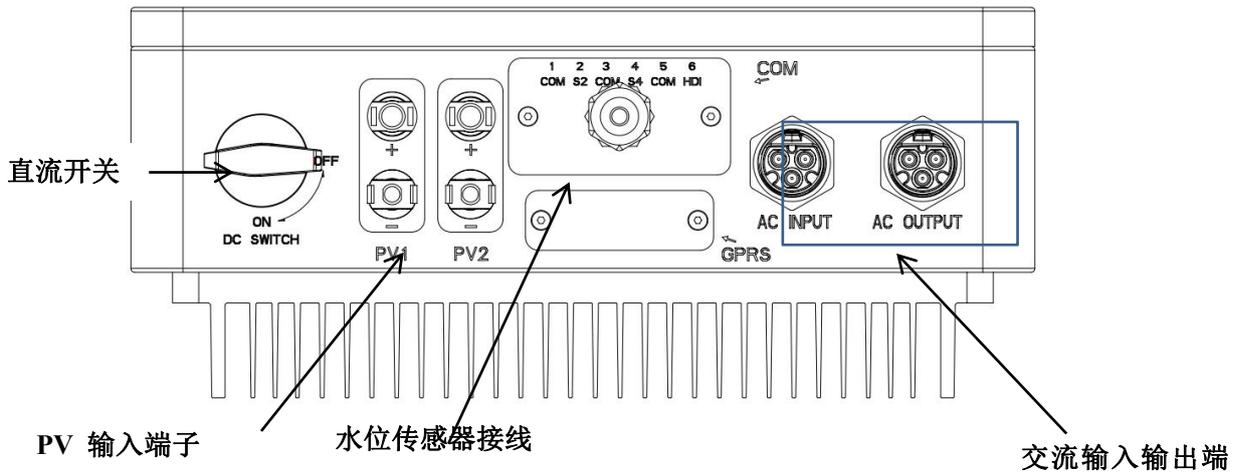
图 2-14 LS- PI 3K to5.5K 系列 接线图
