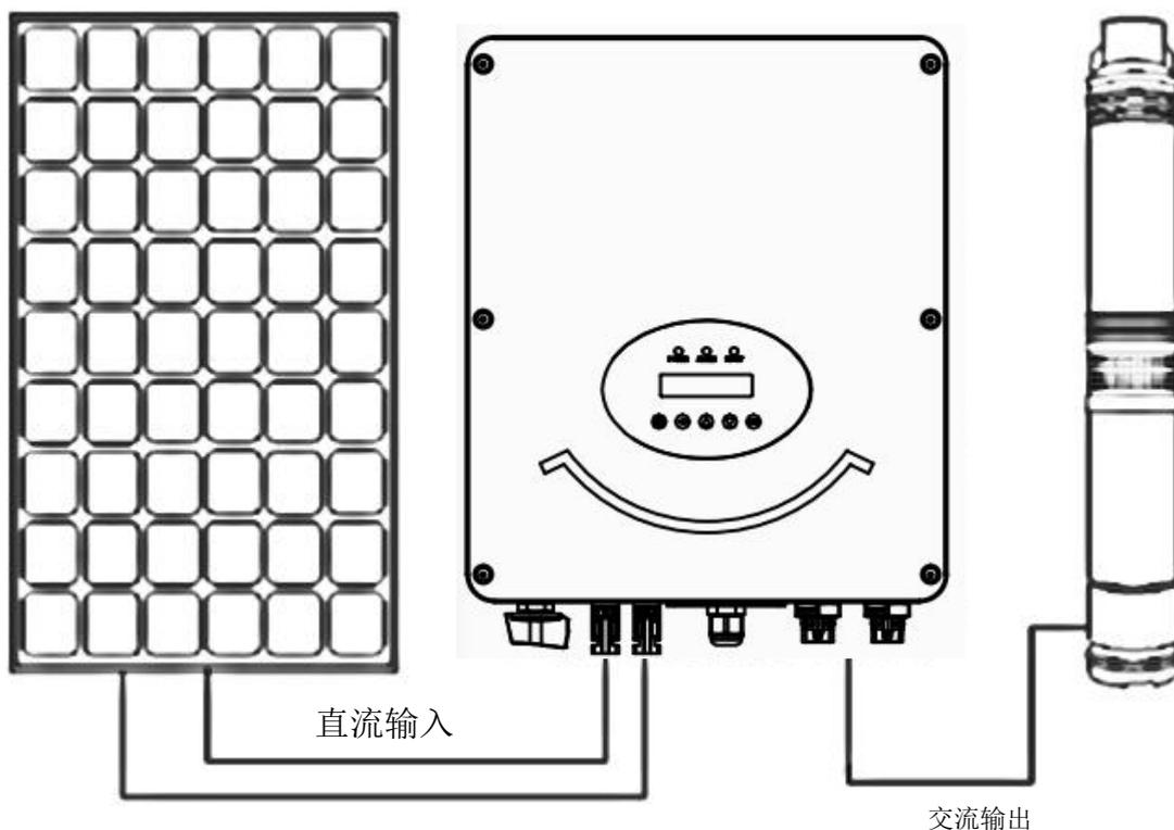
图 1-1 光伏扬水系统结构
