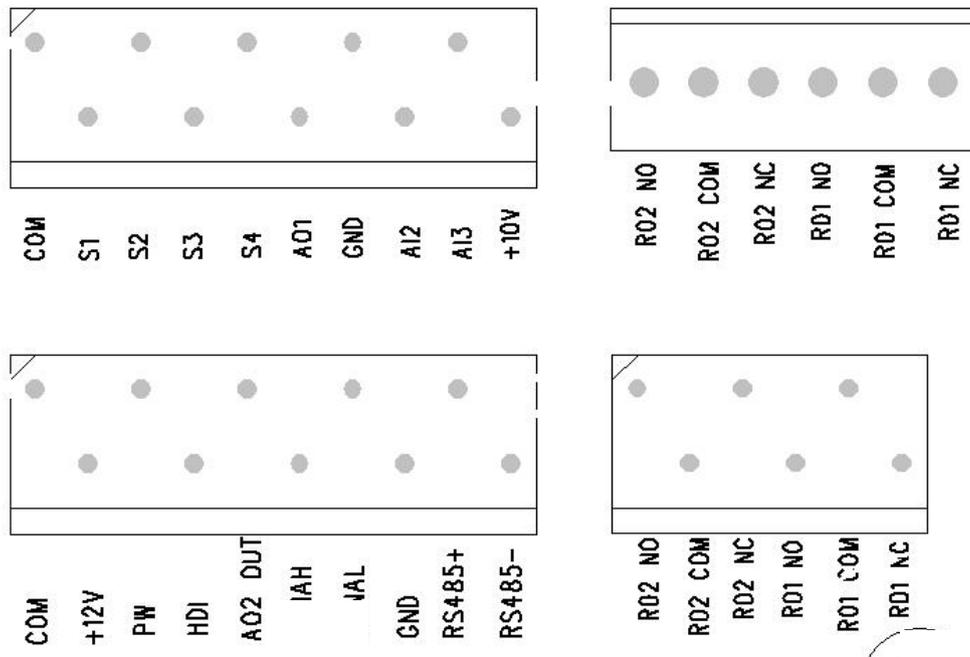
图 2-13 I/O 端子示意图
