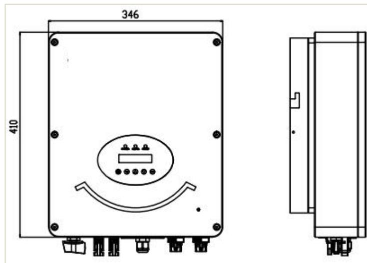
图 2-3 LS-PI-3K to5.5K(G)产品外形和安装尺寸
