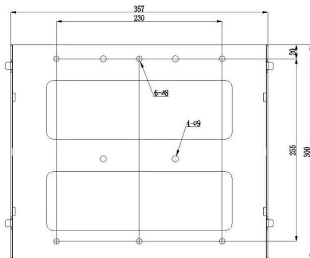
图 2-4 LS- PI 13K to 30 系列安装尺寸
