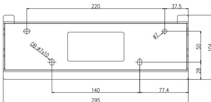
图 2-5 L S PI 3K to 11K (G) 系列安装尺寸
