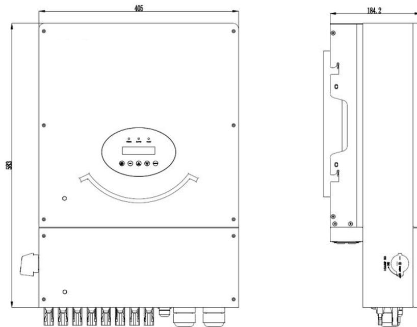
图 2-1 LS-PI-13K to30K(G)产品外形和安装尺寸
