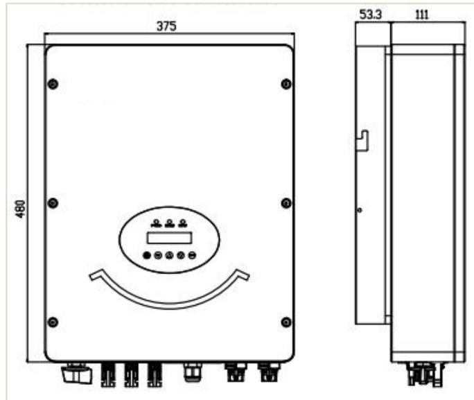
图 2-2 LS-PI-7.5K to11K(G)产品外形和安装尺寸
