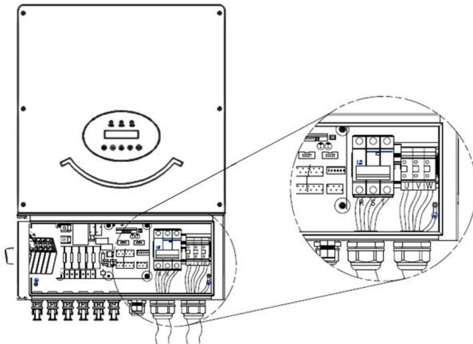
图 2-11 LS-PI-13K(G)to 30K(G)系列接线示意图
