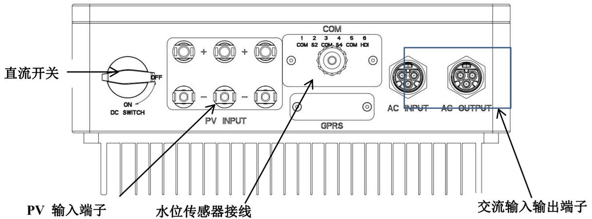
图 2-15 LS-PI 7.5K to11K 系列接线图
